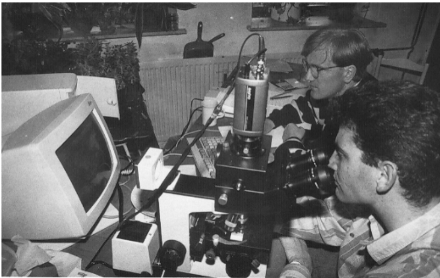
Abbildung 32: Die Kollegen Birkenhauer und Bräuer während der Auswertung an dem Quantimet 500+ ® . Die im Mikroskop eingestellten Bildausschnitte werden mit einer hochauflösenden CCD-Kamera aufgenommen und im Rechner digital verarbeitet.
